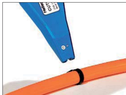
1. CUTties über dem Kabelbinder in Position bringen.
