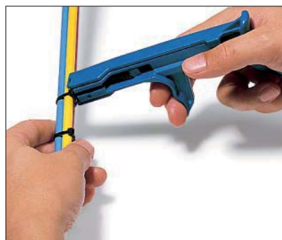
Werkzeug ansetzen, Kabelbinder spannen.
