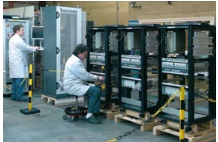
Schrank-Zusammenbau und Integration aller mechanischen, elektrischen und elektronischen Komponenten.
