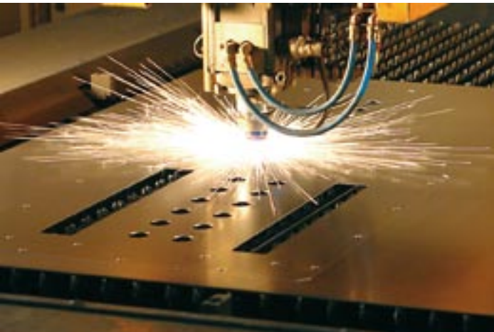
Nachträgliches Einbringen von Ausbrüchen und Lochungen durch Laserbearbeitung bei Standardprodukten mit geringer Stückzahl.
